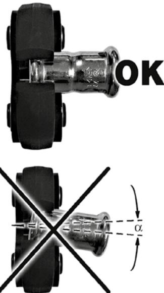
*Non pressare il manicotto a terra / Don't press the pressfitting on the floor*
