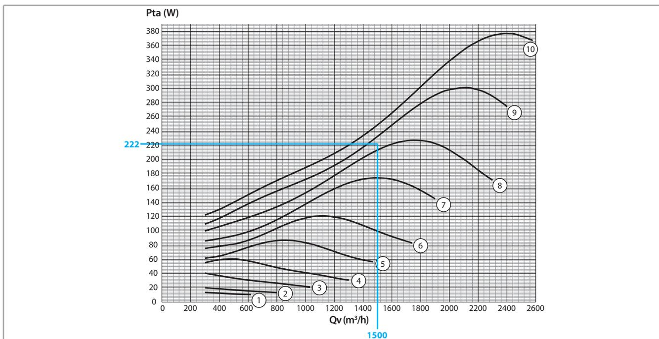
Puissance électrique absorbée = **222 W**
