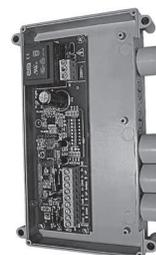
Le Router-S est une carte électronique qui permet de contrôler plusieurs unités dans un réseau géré par Sabianet (défaut) ou dans un sous-réseau géré par le système BMS qui n'est pas livré par Sabiana (un DIP Switch doit être repositionné sur la carte).
