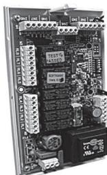
La SIOS est une carte équipée de 8 relais avec contacts secs à utiliser pour contrôler l'allumage ou l'extinction des applications électriques à distance. La carte dispose aussi de 8 entrées numériques utiles pour visualiser l'état des actionneurs ou signaux externes comme les protections thermiques pour le moteur et autre.
