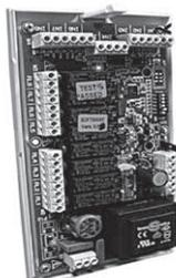
La SIOS est une carte équipée de 8 relais avec contacts secs à utiliser pour contrôler l'allumage ou l'extinction des applications électriques à distance. La carte dispose aussi de 8 entrées numériques utiles pour visualiser l'état des actionneurs ou signaux externes comme les protections thermiques pour le moteur et autre.
