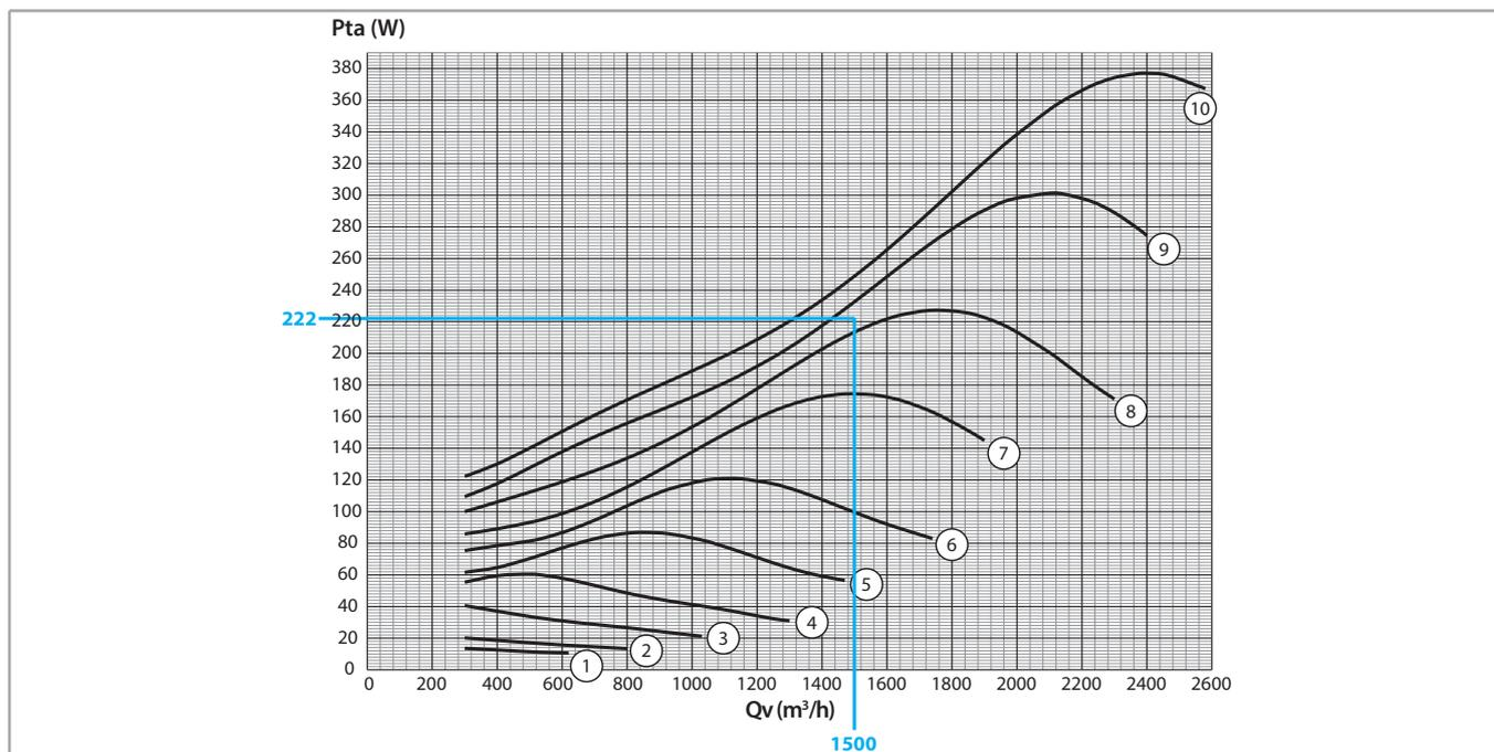
Puissance électrique absorbée = **222 W**
