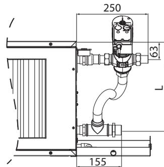
Vannes pour batterie additionnelle (module supplémentaire "Section batterie chaude SBC")
