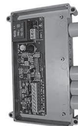
Le Router-S est une carte électronique qui permet de contrôler plusieurs unités dans un réseau géré par Sabianet (défaut) ou dans un sous-réseau géré par le système BMS qui n'est pas livré par Sabiana (un DIP Switch doit être repositionné sur la carte).
