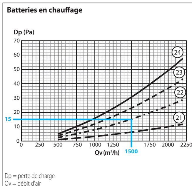
Perte de charge batterie chauffage = **15 Pa**
