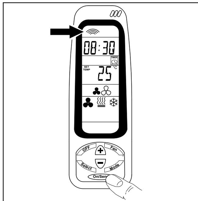
Ogni volta che si vuole modificare i parametri di funzionamento del ventilconvettore occorre inviare le istruzioni premendo il tasto "ON/SEND".
