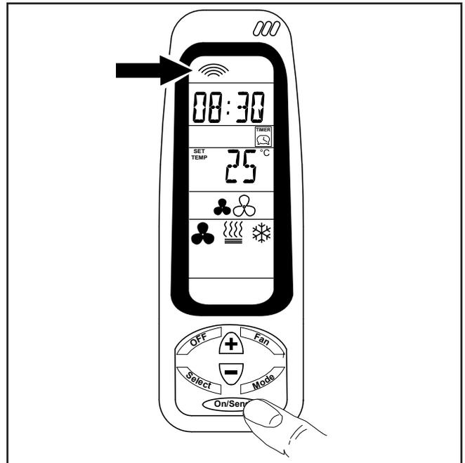
Jedes Mal, wenn die Funktionsparameter des Gebläsekonvektors verändert werden sollen, müssen die Befehle durch Drücken der Taste "ON/SEND" gesen-
