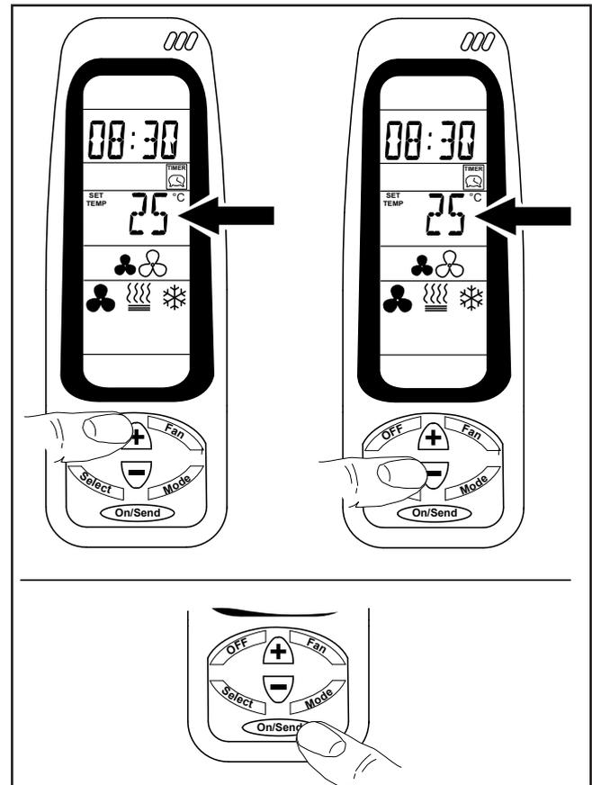
Durch Drücken der Tasten (+) oder (-) kann der gewünschte Temperaturwert erhöht oder reduziert werden.
