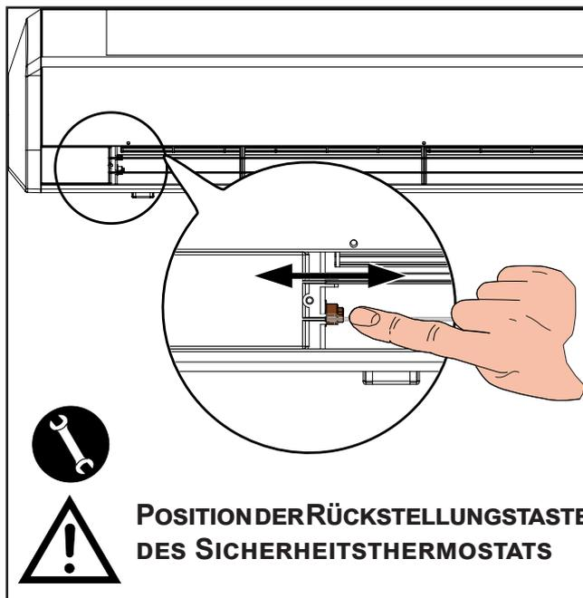
Im Falle eines Eingriffs der Schutzvorrichtung mit manueller Rückstellung kann das System erst rückgestellt werden, nachdem die Spannung getrennt und die Ursache der Störung beseitigt wurde (dieser Eingriff darf ausschließlich vom zuständigen Wartungspersonal ausgeführt werden).
