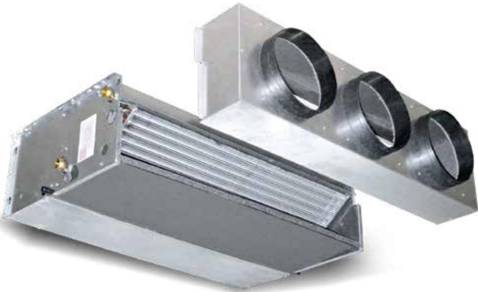
Disponible en **4 tailles** (de 330 à 2460 m<sup>3</sup>/h) avec batterie d'échange thermique à 3 ou 4 rangs, et avec la possibilité d'ajouter une batterie à 1 ou 2 rangs pour les équipements à quatre tubes. Pour les ventilo-convecteurs haute pression, la possibilité **de faire varier** le débit d'air **en continu** apporte une grande flexibilité en termes de régulation et de contrôle, **bénéfique** pour le confort ambiant et la consommation électrique.
