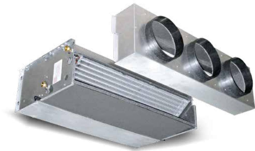
Disponible en **7 tailles** (de 340 à 2.100 m<sup>3</sup>/h) avec batterie d'échange thermique à 3 ou 4 rangs, et avec la possibilité d'ajouter une batterie à 1 ou 2 rangs pour les équipements à quatre tubes.
