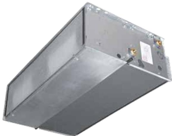
Le débit d'air peut être modifié **de façon continue** au moyen d'un signal 1-10V généré par les commandes de réglage et de contrôle Sabiana ou par des systèmes de réglage indépendants. Cette faculté améliore le confort acoustique et permet une réponse adéquate à la variation des charges thermiques et conduit à une plus grande stabilité de la température souhaitée dans l'ambiance.
