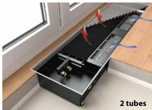
**Turbine tangentielle**, côté fenêtre, avec capot de protection. Moteur EC 24V librement réglable sur la plage de 0 à 10V, pré-câblé et prêt pour le raccordement électrique.
