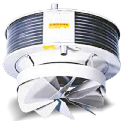
Le diffuseur "DRA" se compose d'une série de jalousies disposées en éventail, orientables et indépendantes, permettant de régler l'ampleur du cône d'air chaud et donc de rendre l'unité idéale soit pour les hauteurs minimales que pour celle maximales. Ce diffuseur permet le réglage de l'air dans les directions souhaitées. À l'exclusion des directions où il n'est pas possible de ventiler.
