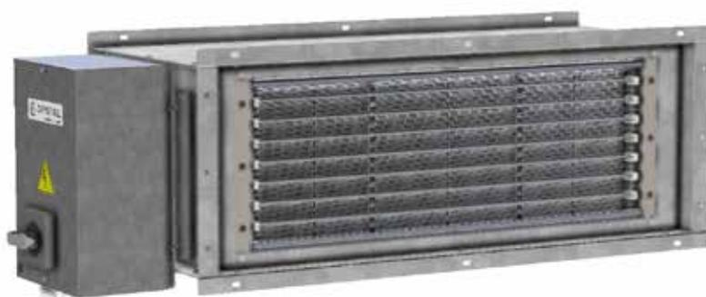
Ce type de plénum a été spécifiquement conçu pour être inséré sur des branches de conduites, typiquement en amont des terminaux de distribution pour la purification de l'air de recirculation secondaire. La structure est en tôle galvanisée, de type suspendu, et est conçue pour être couplée à des canaux à brides. La partie électrostatique active Crystall est positionnée à l'intérieur de celle-ci, constituée d'un ou plusieurs ensembles filtrants, selon le modèle choisi.
