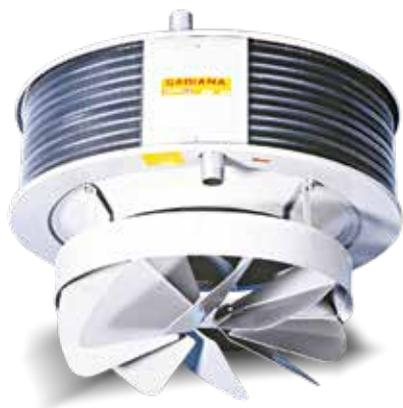
Le diffuseur "DRA" se compose d'une série de jalousies disposées en éventail, orientables et indépendantes, permettant de régler l'ampleur du cône de soufflage.
