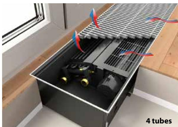
**Conduit au sol** en tôle d'acier zingué, revêtu de peinture de couleur gris anthracite (RAL 7016). Un système externe de réglage de la hauteur est pré-monté avec un dispositif antivibratile. Un bac de récupération des condensats est intégré au conduit au sol, il est muni de deux raccords latéraux de  $\varnothing = 15$  mm.
