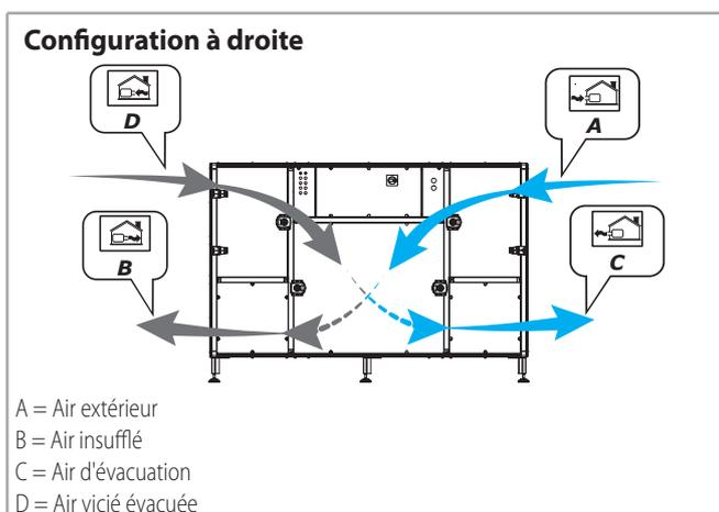
**La configuration gauche ou droite des connexions latérales ne peut pas être inversée après l'achat, l'unité doit donc être sélectionnée en fonction de la configuration de construction nécessaire.**
