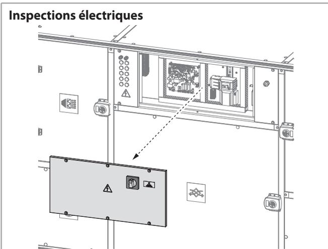
Les panneaux latéraux ne peuvent être démontés qu'en l'absence du panneau central.
