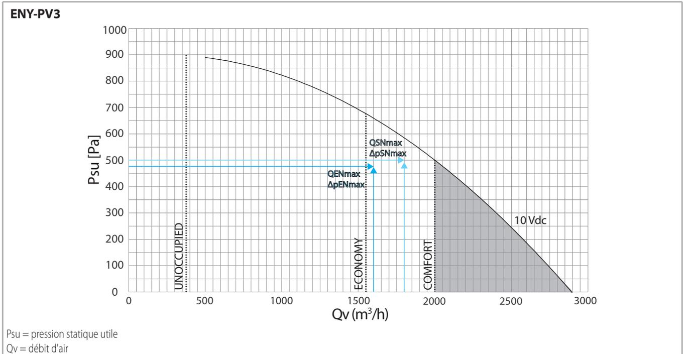
Les unités ENY-PV sont fournies avec des paramètres pré-sélectionnés et dans le cas de ENY-PV3, la sélection implique d'avoir un débit ÉCONOMIE de 1550 m<sup>3</sup>/h supérieur à la valeur de conception minimale souhaitée égale à 1350 m<sup>3</sup>/h.
