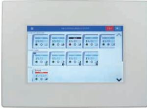
Le panneau de commande T-DI permet de superviser et de contrôler plusieurs unités avec carte électronique MB ou SIOS; le panneau est équipé avec un écran tactile à 7 pouces et une série des pages graphiques qui permettent une lecture facile des données envoyées par les fan coils et le contrôle jusqu'à 60 unités (max. 60 unités: SIOS + MB).
