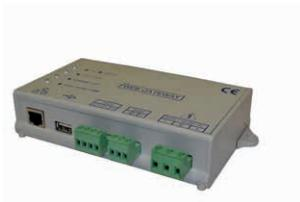
Avec le Web gateway pour "Sabiana Cloud" il est possible de contrôler à distance jusqu'aux 60 unités, équipées avec carte électronique MB ou SIOS (max. 60 unités: SIOS + MB) avec la APP spécifique pour Android et iOS.
