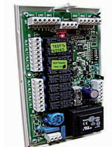
La SIOS est une carte équipée de 8 relais avec contacts secs à utiliser pour contrôler l'allumage ou l'extinction des applications électriques à distance. La carte dispose aussi de 8 entrées numériques utiles pour visualiser l'état des actionneurs ou signaux externes comme les protections thermiques pour le moteur et autre.
