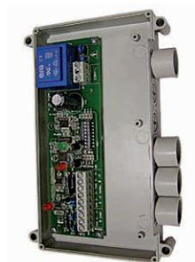
Le Router-S est une carte électronique qui permet de contrôler plusieurs unités dans un réseau géré par Sabianet (défaut) ou dans un sous-réseau géré par le système BMS qui n'est pas livré par Sabiana (un DIP Switch doit être repositionné sur la carte).
