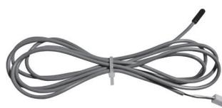
Capteur de type NTC à placer au contact de la tuyauterie d'alimentation d'eau en amont des vannes (non compatible avec la vanne à 2 voies).
