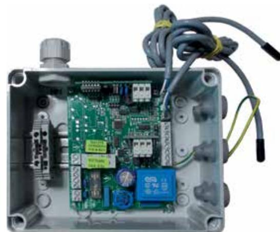
En activant la fonctionnalité de la sonde T3, de température minimum, il est possible d'arrêter le fonctionnement de la ventilation en hiver, quand la température de la batterie est inférieure à 32 °C et de le démarrer quand la température atteint 36 °C. En été, le ventilateur s'arrête lorsque la température de la batterie dépasse 22 °C et s'allume au-dessous de 18 °C.
