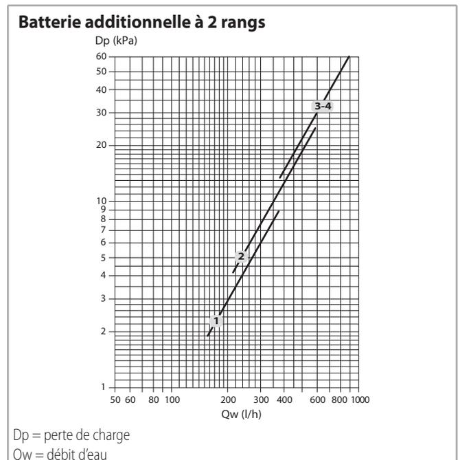
Les pertes de charge font référence à une température moyenne de l'eau de 60 °C. Pour des températures moyennes différentes, multiplier les pertes de charge par le coefficient K reporté dans le tableau suivant.
