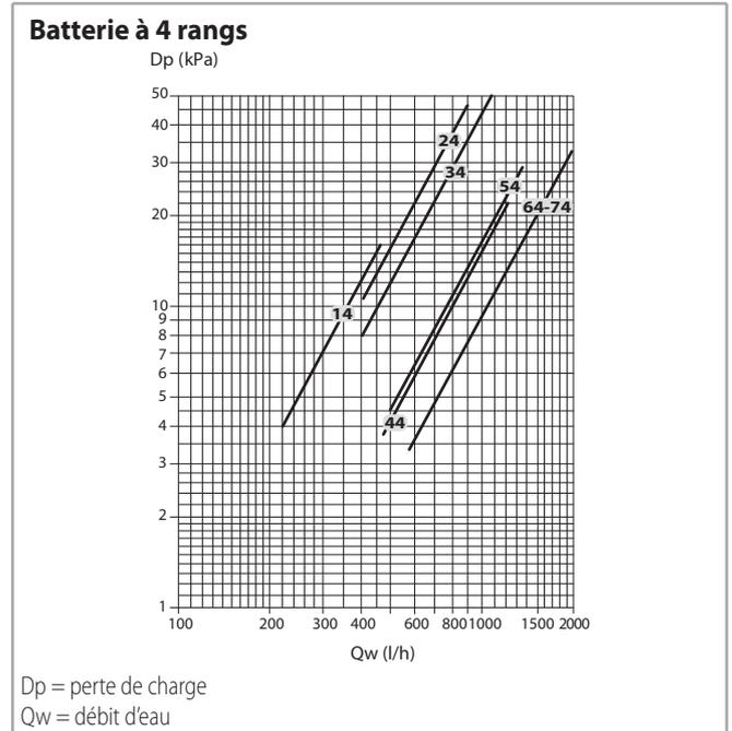
Les pertes de charge font référence à une température moyenne de l'eau de 10 °C. Pour des températures moyennes différentes, multiplier les pertes de charge par le coefficient K reporté dans le tableau suivant.
