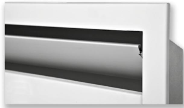
**La grille de reprise d'air** est fixée au kit cadre par un système de couplage rapide simple à appliquer et facile à enlever pour la maintenance du filtre et pour le nettoyage de l'intérieur du boîtier encastrable. Pour le nettoyage ou le remplacement des filtres il suffit d'enlever la grille d'aspiration et ainsi de les faire glisser.
