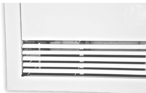
**Le boîtier encastrable** est réalisé en tôle zinguée et il a des ouvertures spécifiques facilitant les raccordements électrique et hydraulique du ventilo-convecteur. Pour faciliter l'assemblage de l'appareil il faut utiliser les quatre tiges filetées mis en correspondance des fentes de fixation du dos fan coil.
