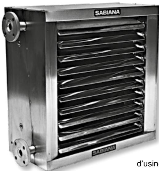
Les aérothermes **AIX** Sabiana sont réalisés avec une structure en acier inoxydable et une batterie d'échange thermique avec des tubes et fixations bridées en acier inoxydable et un bloc muni d'ailettes en aluminium.
