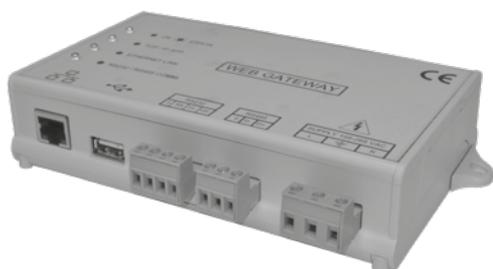
Avec le Web gateway pour "**Sabiana Cloud**" il est possible de contrôler à distance jusqu'aux 60 unités, équipées avec carte électronique MB ou SIOS (max. 60 unités: SIOS + MB) avec la APP spécifique pour Android et iOS.
