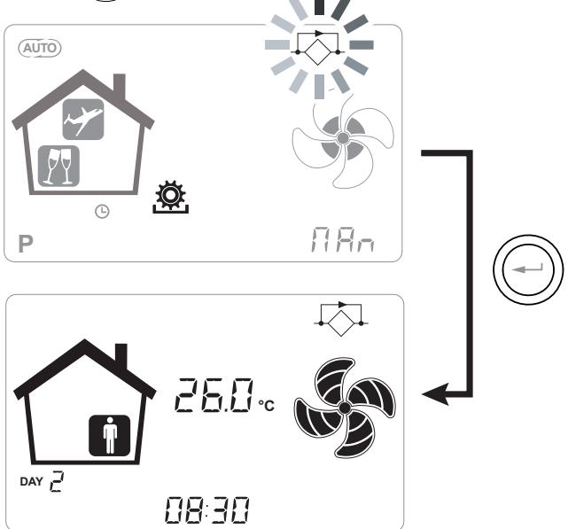
**ATTENTION !** Pour terminer le FREE-COOLING et rétablir la récupération thermique, il est nécessaire de modifier manuellement le mode en accédant à la page-écran de l'utilisateur.
