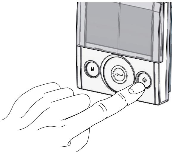
2. Presione simultáneamente las teclas ON/OFF y el Menú "M".
