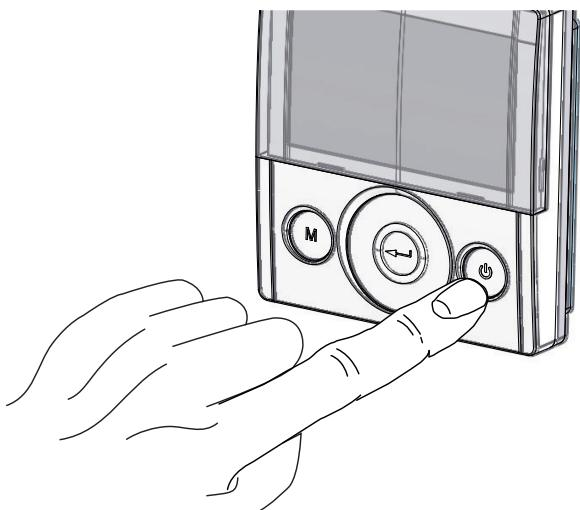
2. Appuyer simultanément sur les touches ON/OFF et Menu « M ».
