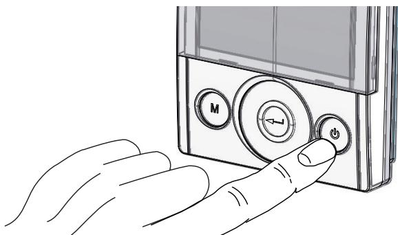
2. Presione simultáneamente las teclas ON/OFF y el Menú "M" para acceder al **MENÚ TÉCNICO**.
