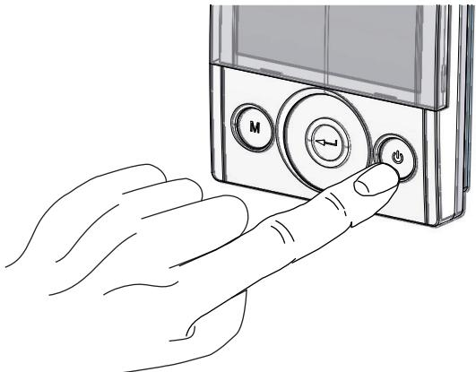
2. Appuyer simultanément sur les touches « On/Off » et Menu « M ».
