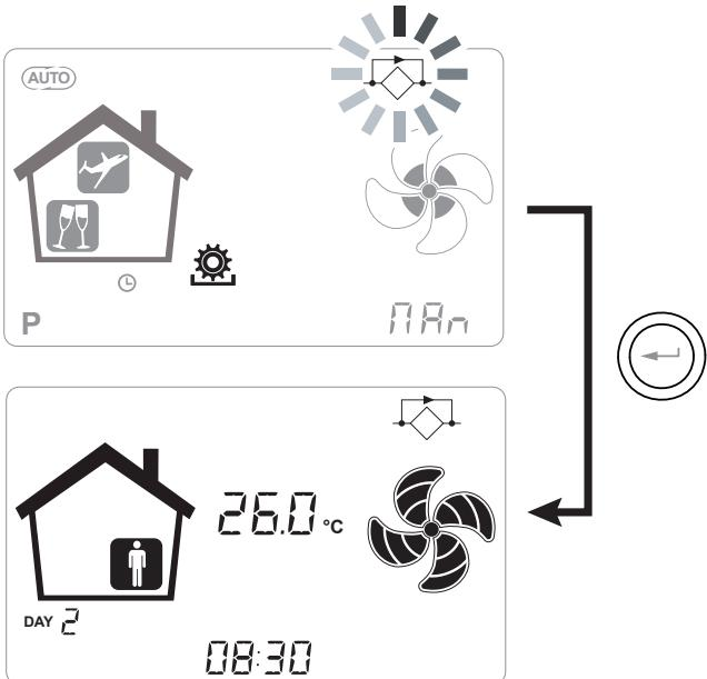
**¡ATENCIÓN!**: Con el fin de terminar el FREE-COOLING y restablecer la recuperación térmica, hay que modificar manualmente la modalidad accediendo a la pantalla usuario.
