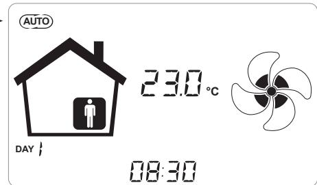
Si le « **Mode Automatique** » est activé, les vitesses du ventilateur sont commandées avec un cycle de contrôle automatique relatif aux variations instantanées de la variable de qualité de l'air mesurée (humidité par défaut). Voir le paragraphe d'approfondissement pour de plus amples détails.
