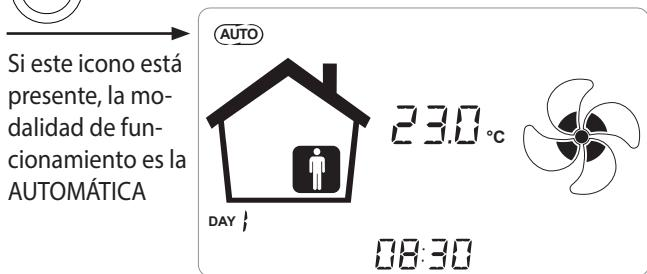
En caso de que esté habilitada la "**Modalidad Automática**", las velocidades del ventilador se controlan mediante un ciclo de control automático relativo a las variaciones instantáneas de la variable de calidad del aire medido (predeterminado, humedad). Consulte el apartado de profundizaciones para más información.
