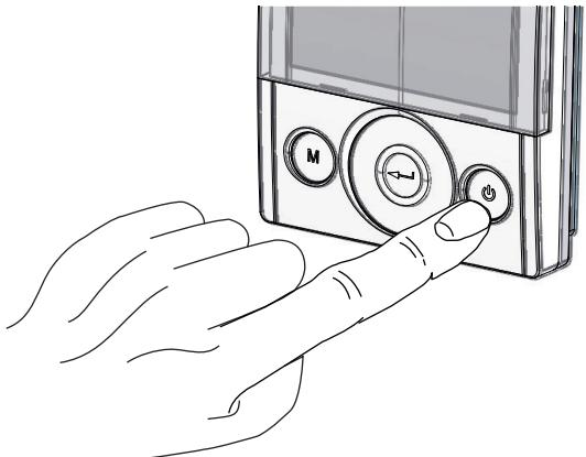
2. Presione simultáneamente las teclas “On/Off” y el Menú “M”.
