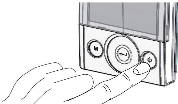
2. Presione simultáneamente las teclas ON/OFF y el Menú “M” para acceder al MENÚ TÉCNICO.
