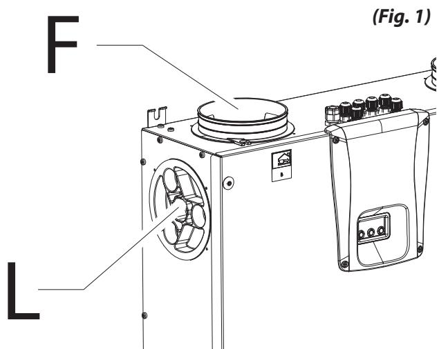
Las espigas están montadas de fábrica en las conexiones de aire frontales (F).
