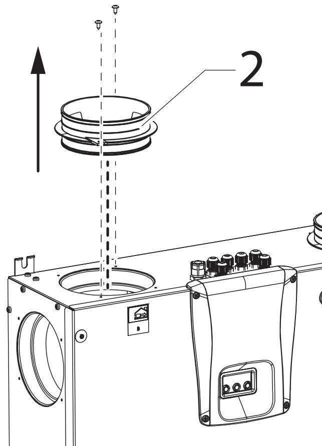
Les piquages sont montés en usine sur les raccords avant de l'air (F).
