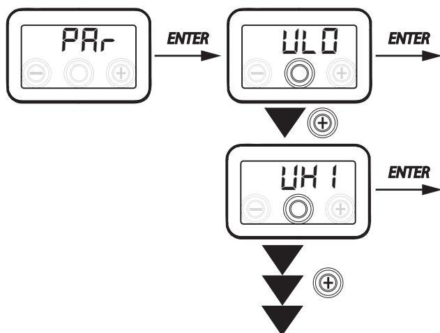
Ce menu permet de modifier les paramètres de fonctionnement de l'appareil.
