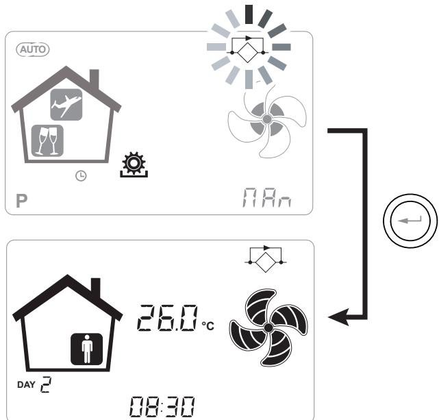
**ATTENZIONE!**: Al fine di terminare il FREE-COOLING e ripristinare il recupero termico, è necessario modificare manualmente la modalità accedendo alla schermata utente.
