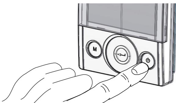
2. Appuyer simultanément sur les touches ON/OFF et Menu « M » pour accéder au **MENU TECHNICIEN**.
