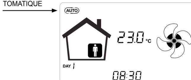
La "Fonction automatique" peut être activée uniquement si les unités sont équipées de systèmes de commande centralisée avancée.
