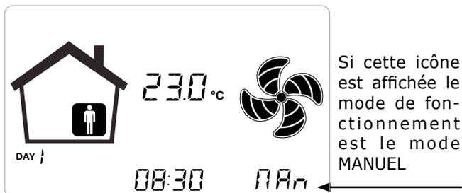
Lorsque la fonction "Ventilation Manuelle" est activée, la vitesse des ventilateurs est réglée à l'aide de la touche capacitive du **TOUCH PAD**. Quand on tourne dans le sens des aiguilles d'une montre on augmente la vitesse du ventilateur, dans le sens inverse des aiguilles d'une montre on diminue la vitesse du ventilateur.
