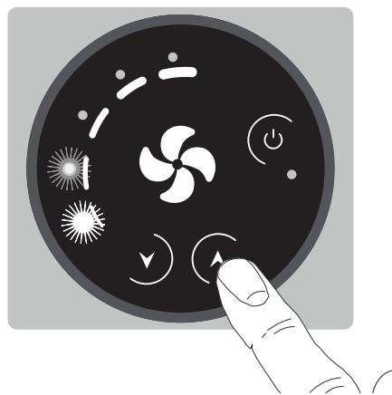
Es posible programar la ventilación ajustando progresivamente la velocidad del ventilador mediante los botones **▼** y **▲**.
