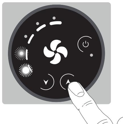
E' possibile impostare la ventilazione agendo in modo progressivo sulla velocità del ventilatore premendo i tasti **V** e **A**.
