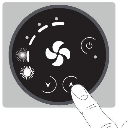
Il est possible de régler l'aération en agissant progressivement sur la vitesse du ventilateur en appuyant sur les touches et .
