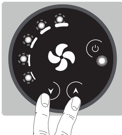
Pour éviter que la vitesse du ventilateur, une fois sélectionnée, ne soit modifiée par d'autres personnes, la fonction « verrouillage des touches » peut être activée.
